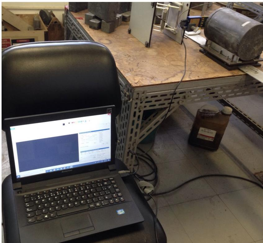
Figura 25: Arranjo experimental para as medidas com a fonte de Césio-137.
