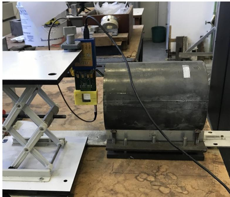
Figura 27: Arranjo experimental para as medidas com a fonte de cézio-137 com incidência longitudinal.
