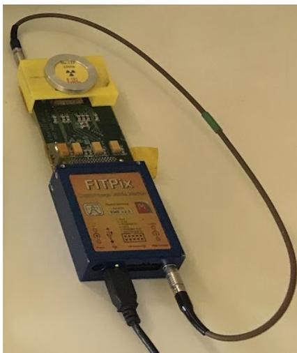
Figura 16: Foto da montagem do detector TimePix com a interface de leitura Fitpix e os cabos utilizados para as conexões entre eles.
