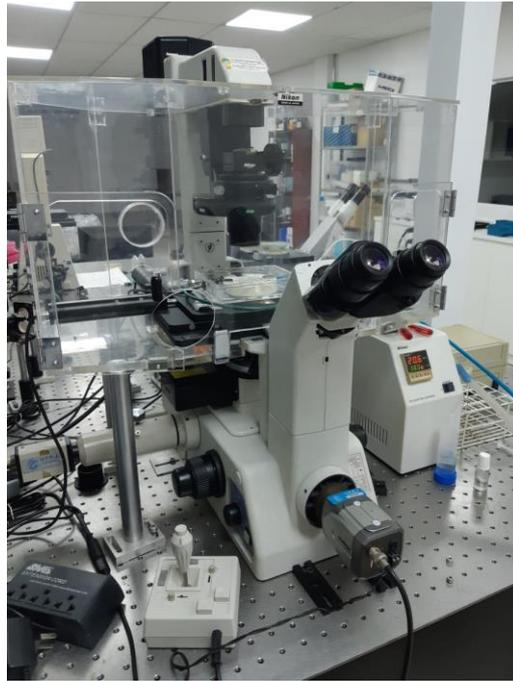
Figura 12 – Microscópio Nikon ECLIPSE TE300 com a estrutura de acrílico montada em volta, a fim de manter as condições ótimas de cultivo de células vivas.
