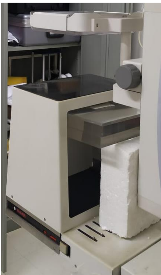
Figura 24 – Configuração do conjunto PMMA/lâmina para obter imagens de magnificação de 1.5 para o foco fino.
