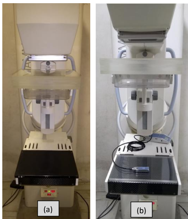
Figura 22 – (a) Obtenção da imagem para avaliar a curva de resposta do detector. (b) Medida do Ki no detector de imagem utilizando o UNFORS.
