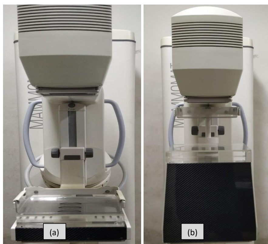
Figura 23 - Configuração para obter imagem da MTF simulando: (a) mamografia de contato (b) mamografia com magnificação.
