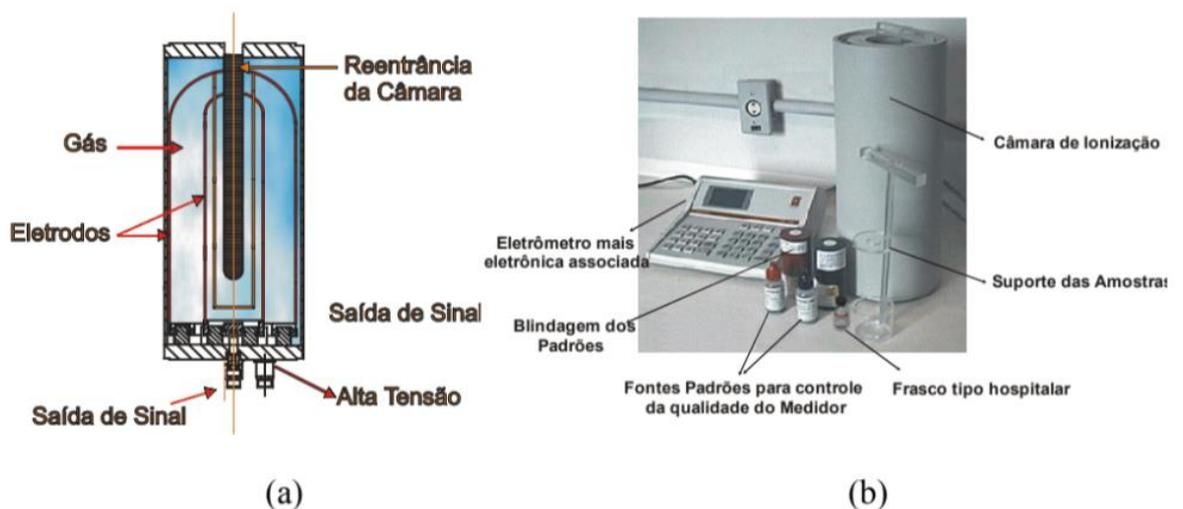
Figura 11: (a) Vista interna de uma câmara de ionização; (b) Calibrador de dose (câmara de ionização conectada a um eletrômetro) (TAUHATA et al., 2013).
