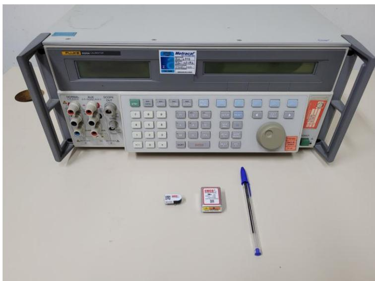
Figura 15: Comparação entre as três fontes de alta tensão usadas durante o trabalho. Calibrador de alto desempenho FLUKE 5520A, e conversores DC-DC EMCO modelos: A05P-5 (esquerda) e C05 (direita).
