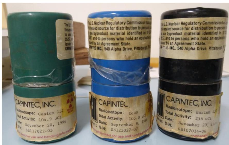
Figura 21: Fontes disponíveis no Serviço de Instrumentação. Da esquerda para a direita: Cs-137, Co-60 e Ba-133.
