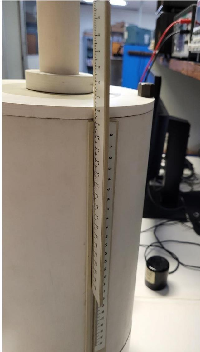
Figura 23: Ajuste do suporte dos radionuclídeos à fim de garantir que fiquem na mesma posição dentro da câmara para diferentes medições. O parâmetro utilizado foi coincidir o zero da régua da câmara com os 10 centímetros da régua do suporte.
