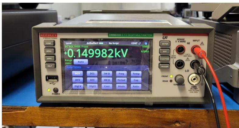
Figura 22: Multímetro utilizado durante o teste de alta voltagem.
