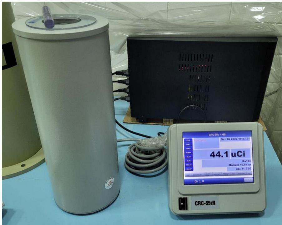
Figura 28: Calibrador de dose comercial CRC-55tR fazendo a leitura da fonte de Ba-133 inserida.
