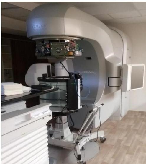
Figura 26 - Esquema de posicionamento do Simulador 3D Scanner™ em relação ao TrueBeam®.
