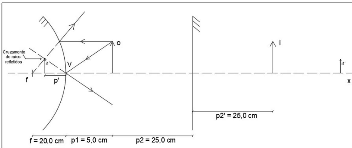
Representação dos raios notáveis para reflexão no espelho convexo. A posição do foco (f) e vértice (V) deste espelho estão indicadas.  $i_1$  é a imagem formada pelo objeto O no espelho convexo,  $i$  é a imagem formada por O no espelho plano e  $i'_1$  é a imagem formada no espelho plano por  $i_1$ , que funciona como objeto para esse espelho.
