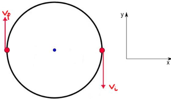
Adotando os eixos coordenados da figura, suas componentes verticais valem  $v_f = +10 \text{ m/s}$  e  $v_i = -10 \text{ m/s}$ . Além disso, sabendo que a esfera tem massa  $m = 100 \text{ g} = 0,1 \text{ kg}$ , podemos calcular o módulo do impulso utilizando a equação acima:
